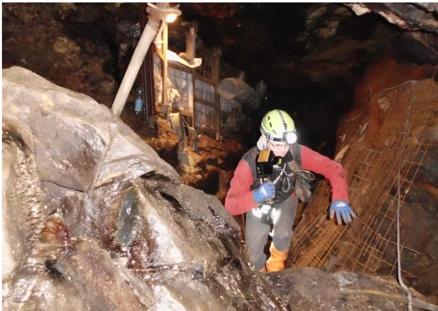
Abb. 6: Vermessung von Altbergbau mittels handgeführten Laserscanner (Quelle: TU Bergakademie Freiberg)
