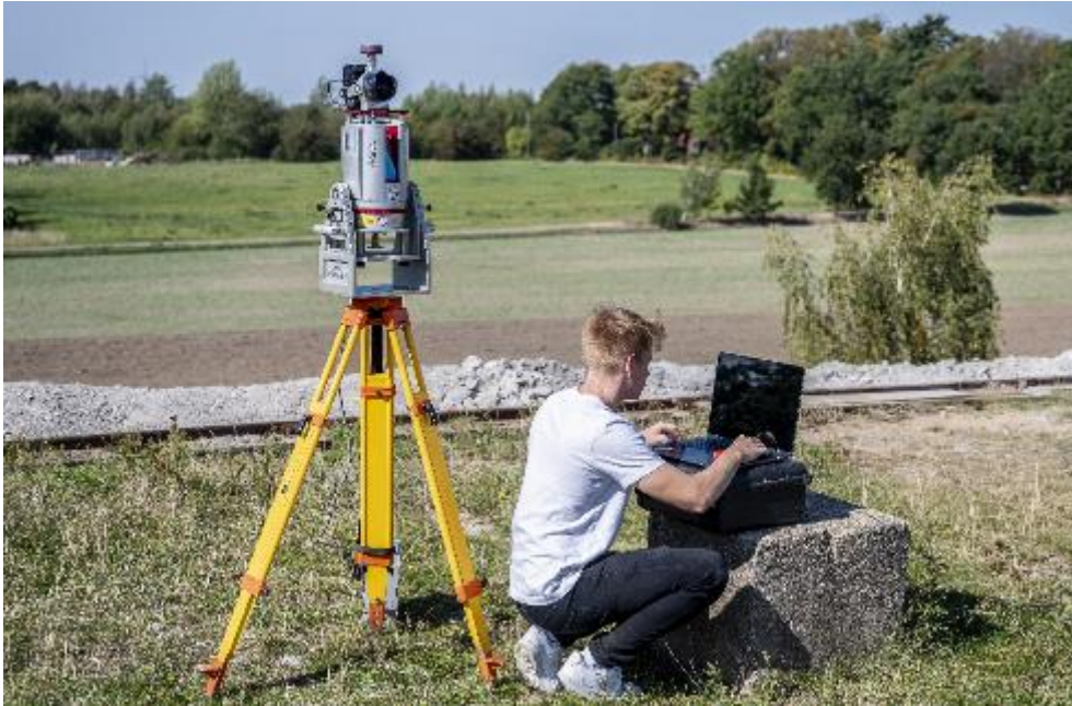
Abb. 5: Einsatz eines Multi-Sensorsystems (Laserscanner und RGB-Kamera) im übertägigen Geomonitoring (Quelle: TU Bergakademie Freiberg)
