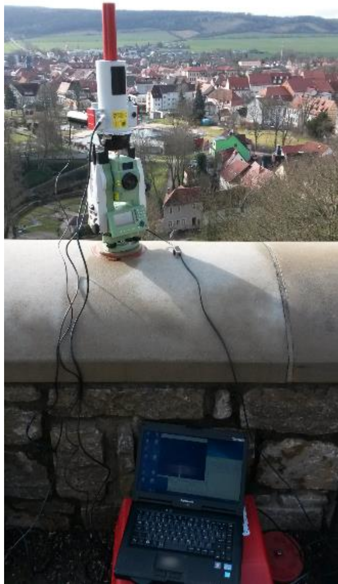
Abb. 1: Aufsatzkreisel GYROMAX AK2M im Einsatz auf einer übertägigen Eichstrecke (Quelle: TU Bergakademie Freiberg).
