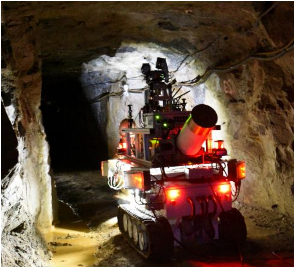
Abb. 7: Autonom messendes robotergestütztes Multi-Sensorsystem, entwickelt im BMBF-Verbundprojekt UPNS4D+ (Quelle: TU Bergakademie Freiberg)
