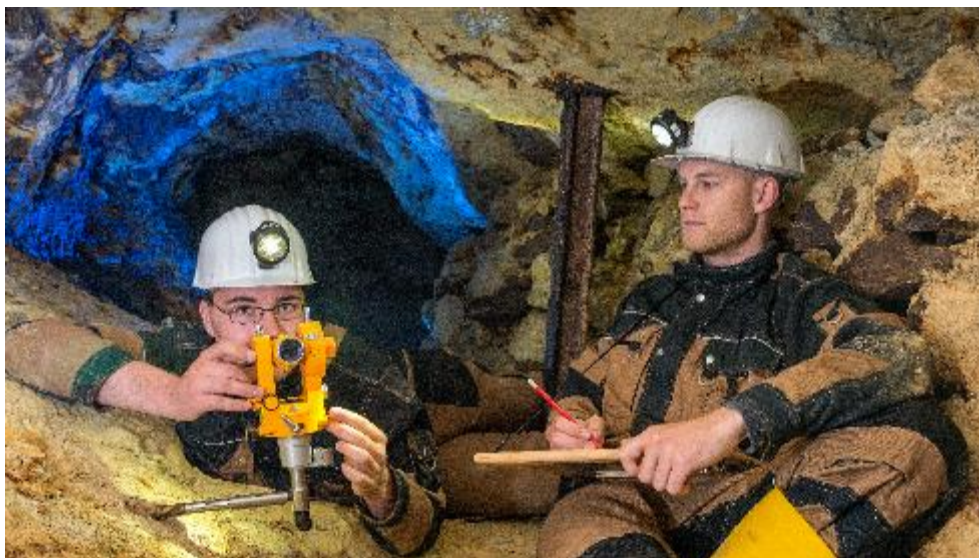
Abb. 4: Messung mit Kleintheodolit in einem Abbau (Quelle: TU Bergakademie Freiberg)
