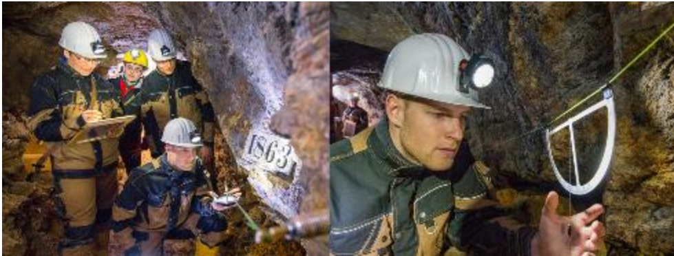
Abb. 2: Messung mit Markscheiderhängezeug im Lehr- und Forschungsbergwerk Reiche Zeche in Freiberg (links: Messung mit dem Hängekompass, rechts: Messung mit dem Gradbogen) (Quelle: TU Bergakademie Freiberg)
