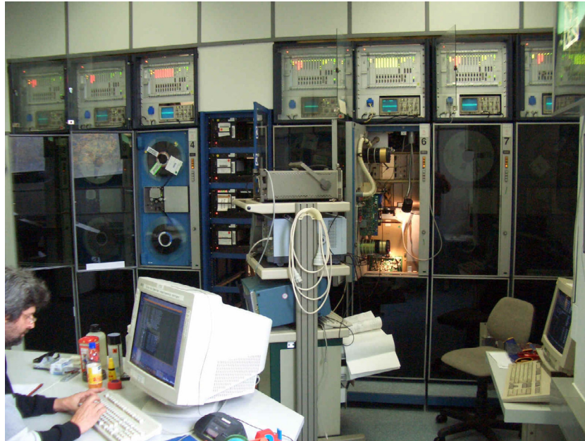
Abbildung 2.3: BKG-MPIfR-Korrelator mit Bandmaschinen, MK-5a-Systemen und den „Station Units“ (über den Bandmaschinen)
