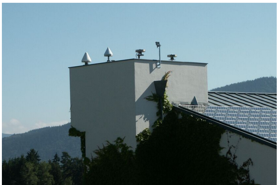
Abbildung 3-4: GNSS-Antennen am Geodätischen Observatorium Wettzell
