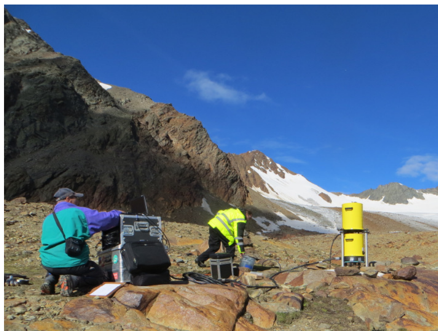
Abbildung 3-6: Terrestrische Schweremessungen mit dem Absolutgravimeter A10 im August 2014 am Vernagtferner in Österreich
