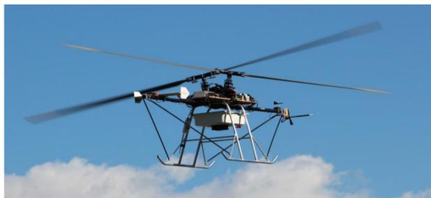
Abb.: AREA-Forschungsdrohne, entwickelt von HT und DLR
