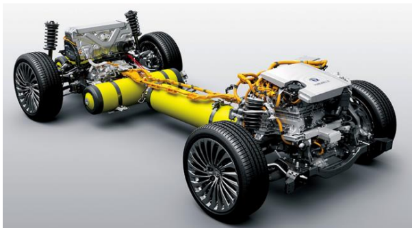
Abbildung: On-Board-Wasserstoff-Druckbehälter aus dem Toyota Mirai, Verbundaufbauten des Druckbehälters.
