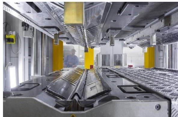
Abbildung 2: Nasspresswerkzeug in der Automobilindustrie [Quelle: CompositesWorld / BMW]
